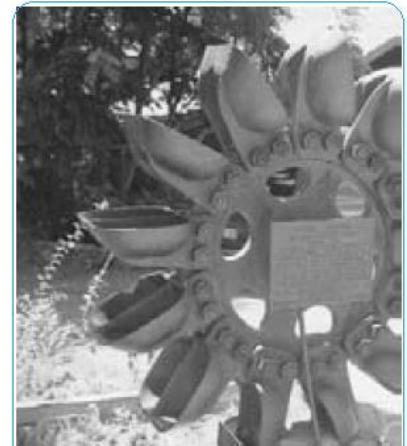
La rueda de Pelton. Las aspas curvadas hacen que el agua rebote y haga una vuelta en U, lo cual produce mayor impulso para hacer girar la rueda.
