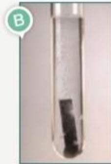
◀ Se sumerge una lámina metálica en una disolución ácida y se ve una reacción rápida con liberación de un gas.
