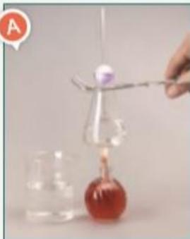
◀ Puso 5 mL de disolución de amoníaco en un matraz y le ajustó un tapón al que adaptó un tubo de vidrio. Luego, calentó el amoníaco hasta que comenzó a observar que el vapor de amoníaco ascendía por el tubo de vidrio.
